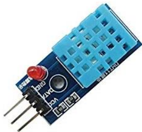
Fig:3 Humidity sensor
